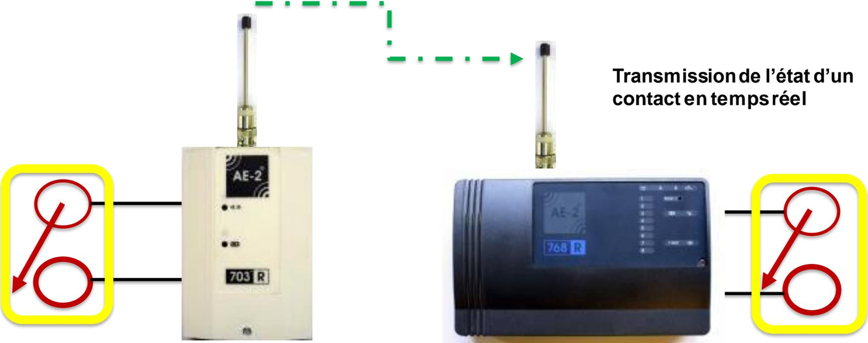
Transmission de l'état d'un contact en temps réel
